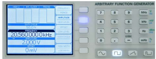
Abb. 4.5: Frontansicht mit Anzeige für die geänderte Amplituden-einstellung
