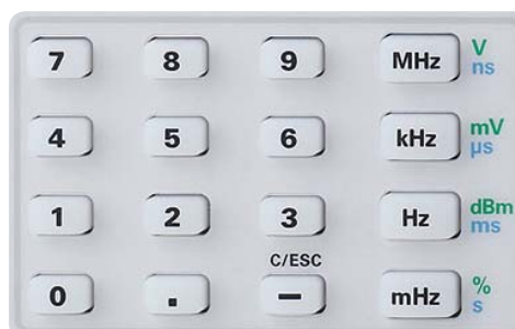
Abb. 4.2: Numerische Tastatur mit Einheiten und ESC Tasten
