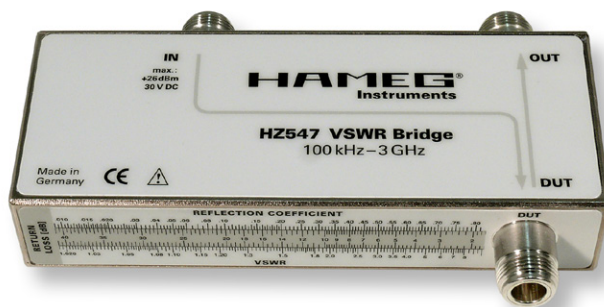
Abb. 12.2: VSWR-Messbrücke HZ547 für HMS1010/3010
