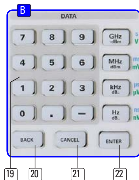
Abb. 4.1: Abschnitt B mit numerischer Tastatur, Einheiten- und Bearbeitungstasten
