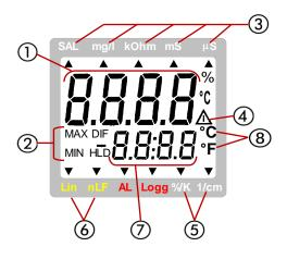
Hauptanzeige: Leitfähigkeit, spez. Widerstand, Filtrat-Trockenrückstand (TDS), Salinität bzw. Benutzerführung
