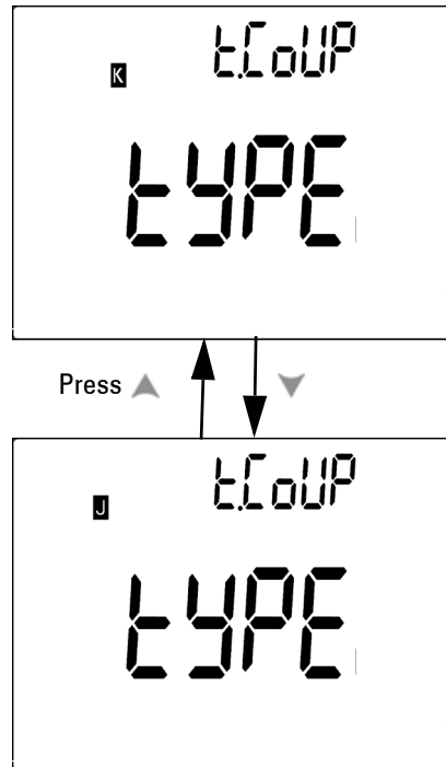
Abbildung 4-3 Einrichtung des Thermoelementtyps
