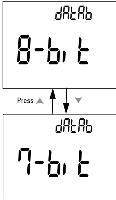
Abbildung 4-13 Einrichtung des Datenbits für die Fernsteuerung
