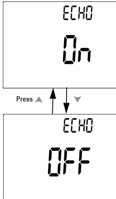
Abbildung 4-14 Einrichtung des Echomodus für die Fernsteuerung
