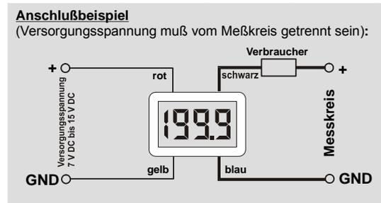
Bei den Modulen **EX2077** und **EX3077** ist der Shunt nicht im Modul integriert. Somit gilt hier derselbe Aufbau wie für „Strommessung mit externem Shunt“ (Spezialfälle S.7).
