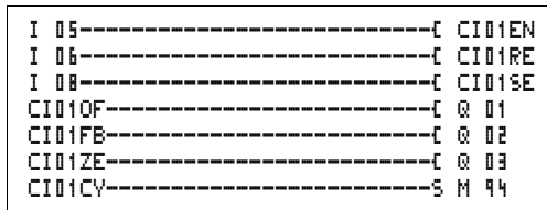
Abbildung 77: easy800-Schaltplan mit schnellem Inkrementalwertgeber-Zähler
