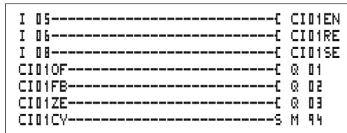
Abbildung 77: easy800-Schaltplan mit schnellem Inkrementalwertgeber-Zähler
