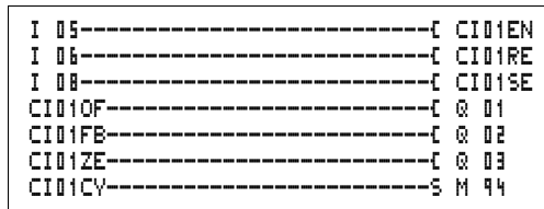
Abbildung 77: easy800-Schaltplan mit schnellem Inkrementalwertgeber-Zähler
