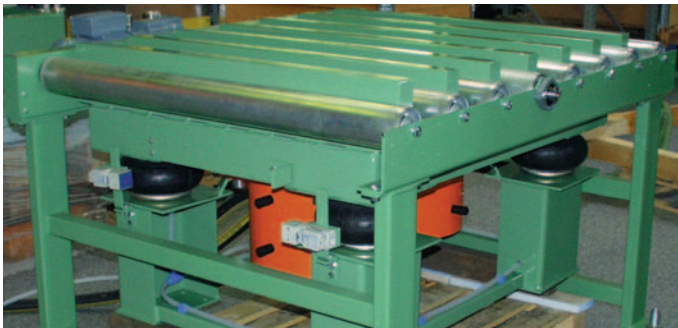
Verdichten von Formsand in Gießereiformen
