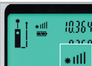
Reflexionsstärke bewerten mittels Skalenanzeige
